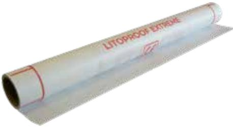
Membrana in rotoli per impermeabilizzazioni sotto-piastrella in balconi, terrazze e piscine. Costituita da due strati di tessuto non tessuto in polipropilene, termo-saldati ad uno strato di polietilene che garantisce la totale impermeabilità delle superfici.
