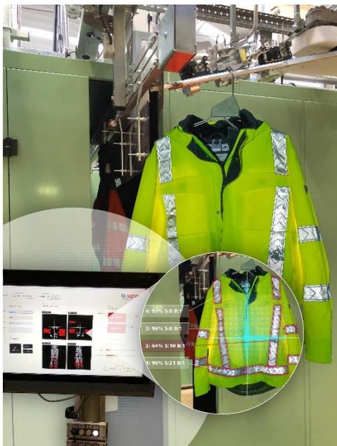
Il sistema di controllo automatico dell'abbigliamento ad alta visibilità, sviluppato da MEWA e dall'Istituto Fraunhofer, garantisce con maggior sicurezza e precisione che gli indumenti soddisfano gli elevati requisiti di sicurezza anche dopo il lavaggio.
