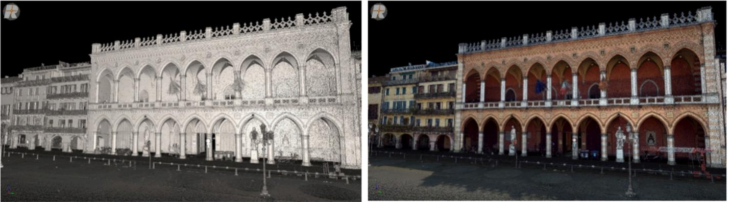
Fig. 11 - Rappresentazione in modalità toni di grigio e RGB della nuvola di punti del prospetto.
