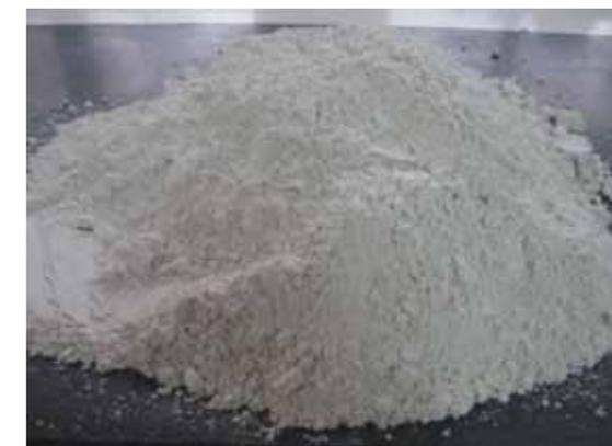
A sinistra, due linee di produzione dell'acido fluoridrico gas; a destra, un particolare dell'anidrite "sintetica" al termine del processo di macinazione
