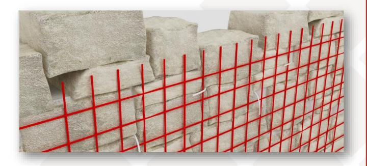
A differenza dei sistemi di rinforzo FRCM, nel caso di sistemi CRM, lo spessore dei sistemi di rinforzo CRM è compreso, di norma, tra 30 mm e 50 mm, al netto del livellamento del supporto e la distanza netta tra i trefoli non può essere superiore a 4 volte lo spessore della malta e comunque non può essere minore di 30 mm.
