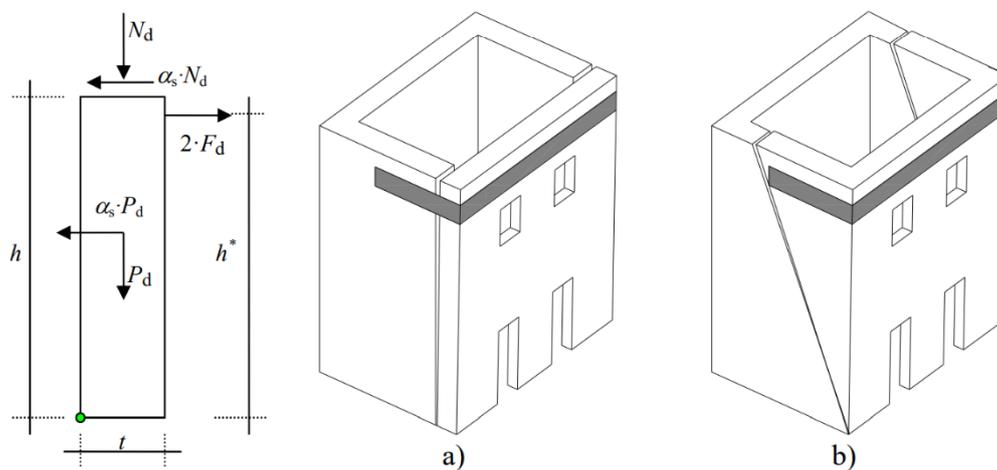
Schema di calcolo per il meccanismo di collasso di ribaltamento semplice.
