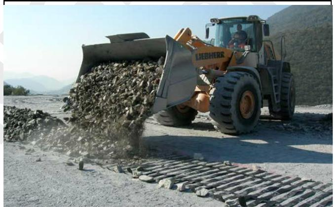
Test di danno da installazione
