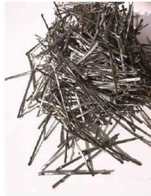
acciaio sono conformi alla normativa UNI EN 14889-1 gruppo 2 hanno forma piatta, con sezione rettangolare. Queste caratteristiche hanno maggiori vantaggi rispetto alle fibre con sezione circolare ottenute da filo:
