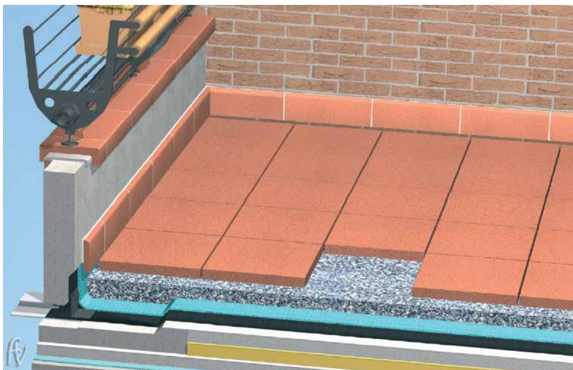
Vista d'insieme della pavimentazione di una loggia con rivestimento in piastrelle di "cotto" su strato di ghiaio
