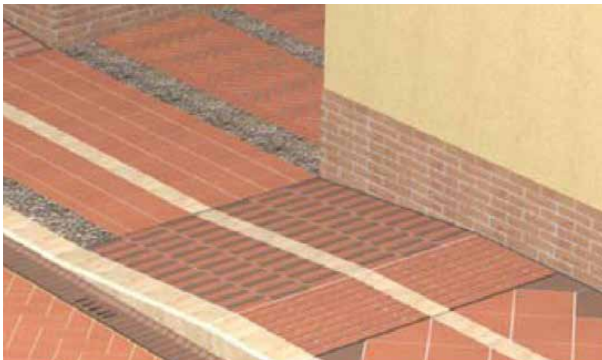
Pavimentazione di marciapiede in laterizio in corrispondenza dell'accesso di un garage
