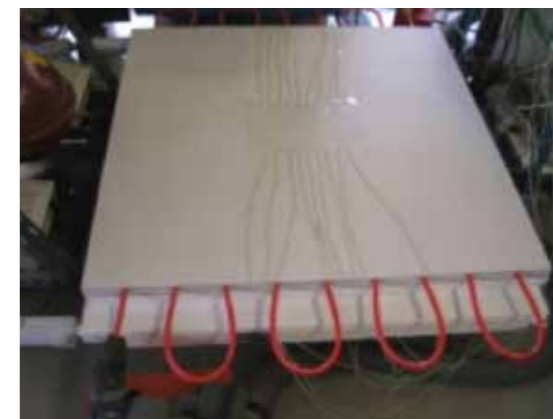
Figura 2 - Prova di laboratorio secondo UNI EN 1264-2
