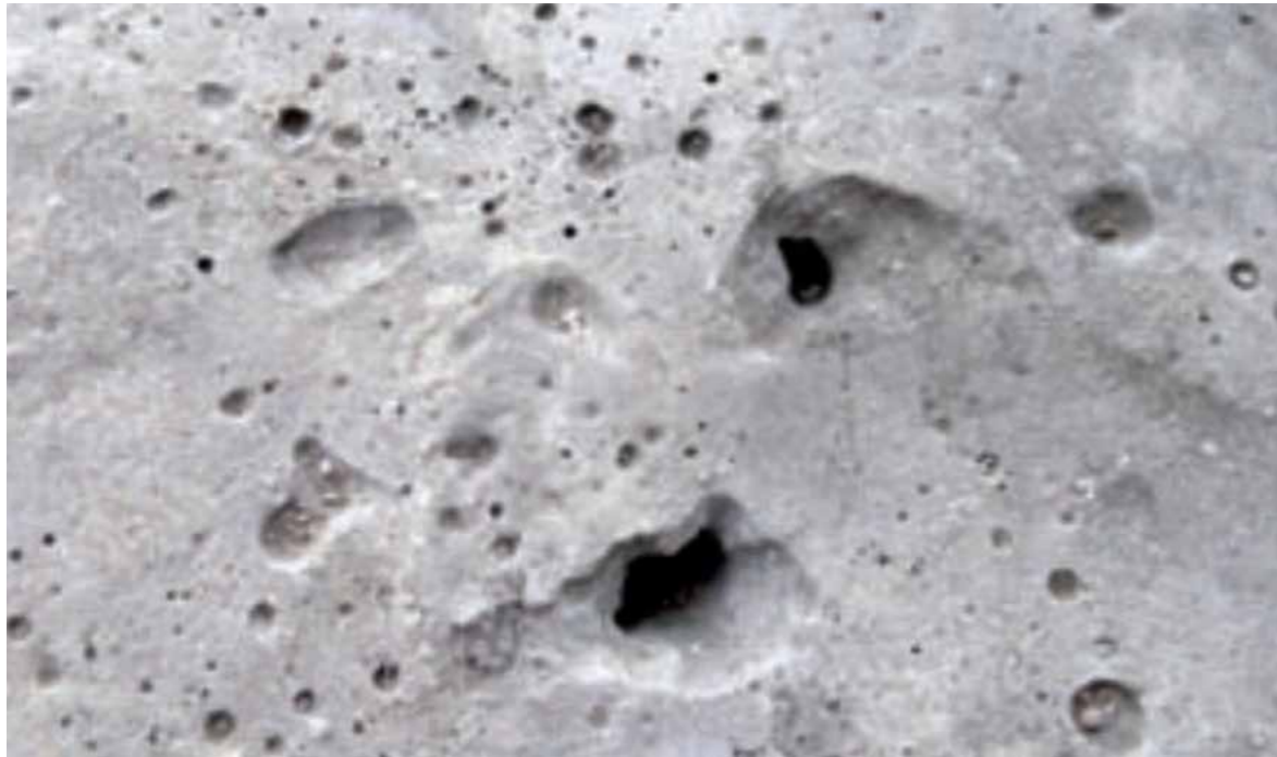
Superficie di distacco con cunicoli di essudazione ritardata
