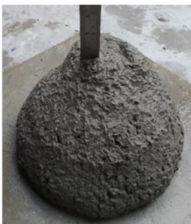
Riduzione della fluidità/lavorabilità a causata da SRA antievaporante
