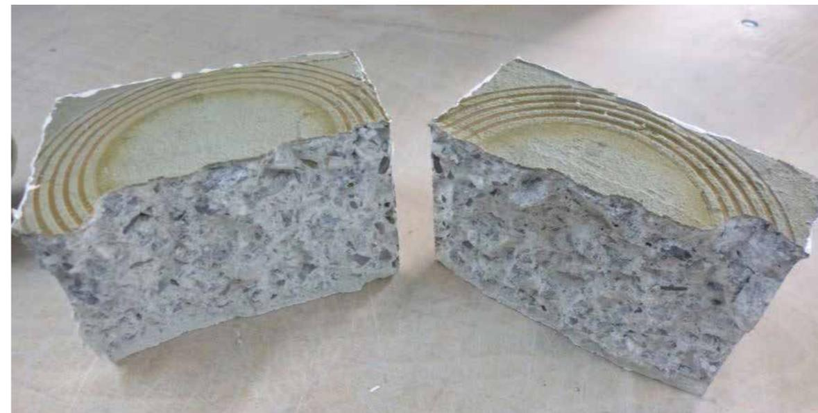
Foto 1 - Provino rotto a compressione per valutare la penetrazione all'acqua dopo la prova di impermeabilità
