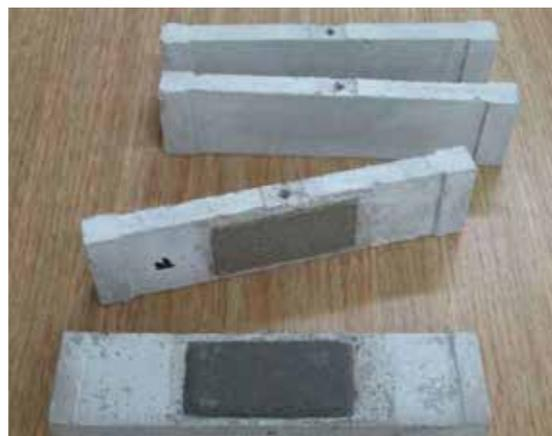
Foto 2 - Prismi di malta di supporto su cui è stata applicata la guaina per la prova di crack bridging
