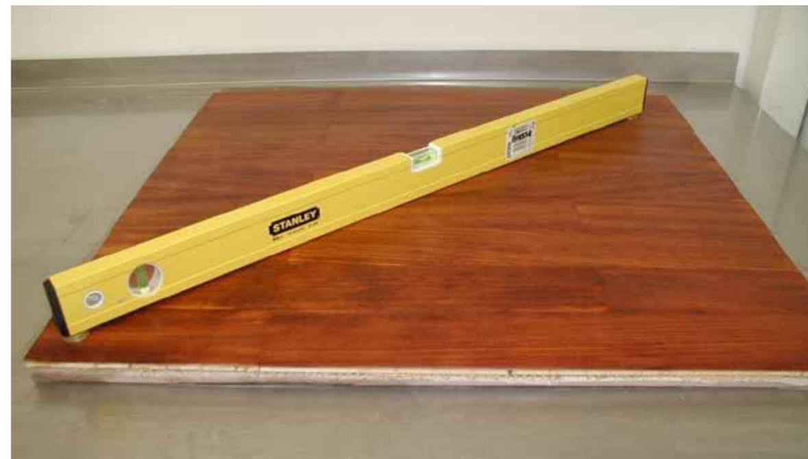
*Imbarcamento del parquet che, alla fine della prova, ha trascinato con sé l'autolivellante cementizio ad esso aderente (da notare le monete agli estremi della bolla)*
