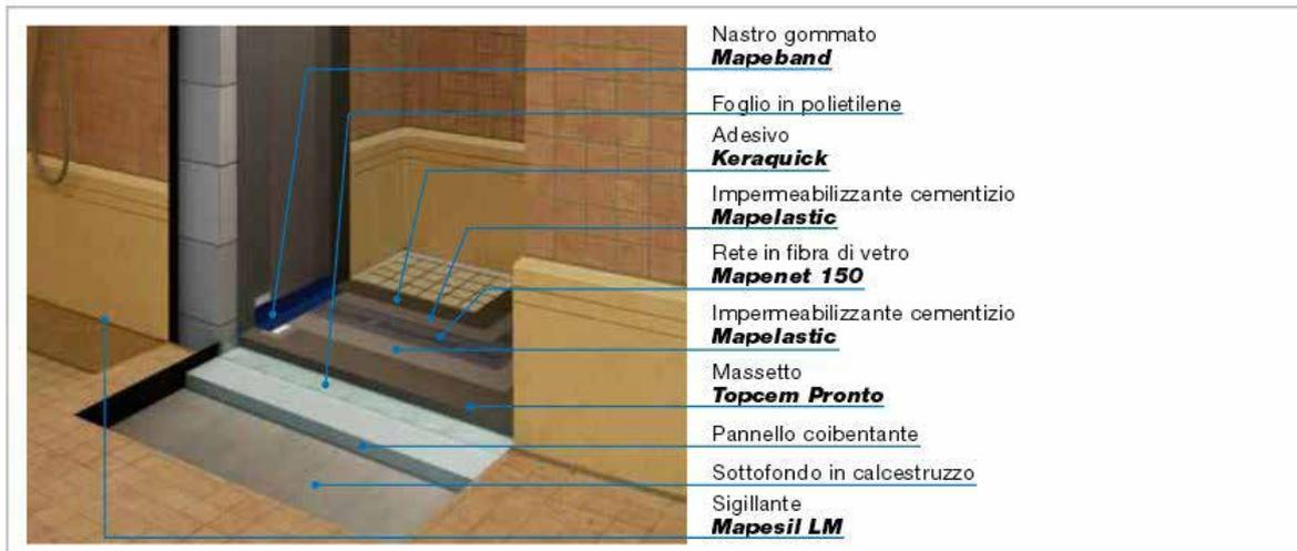
Figura 4.3.1 - Esempio di massetto desolidarizzato posizionato su di uno strato di isolamento termico
