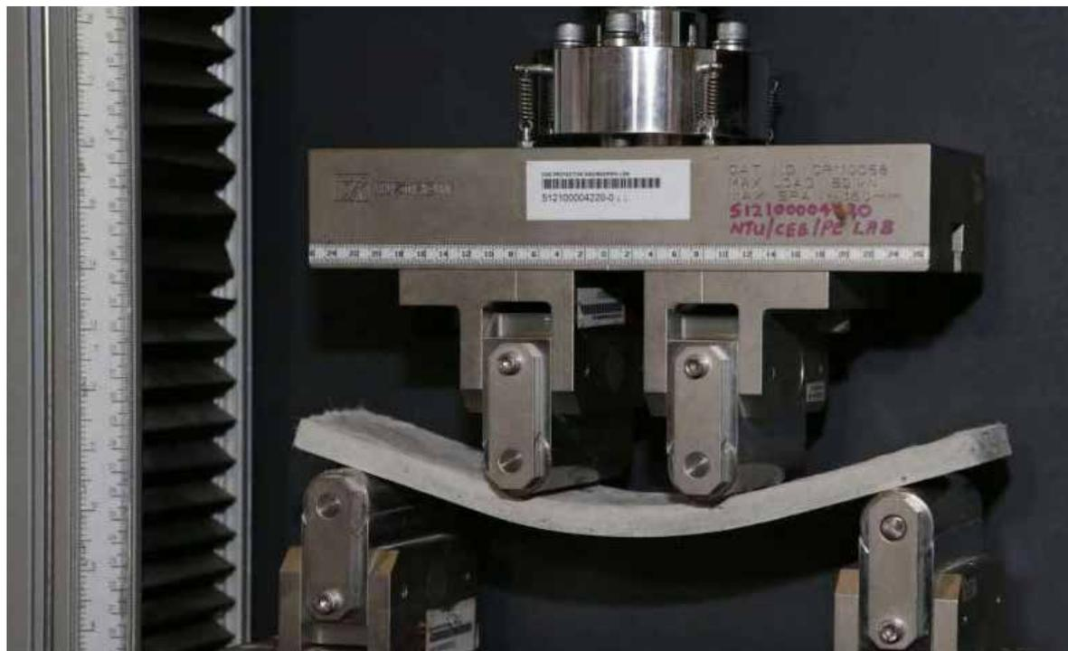
Ma ConFlexPave è almeno due volte più duro di un calcestruzzo regolare, il che significa che le lastre utilizzate possono essere la metà dello spessore, rendendoli più leggere e più facili da trasportare e installare. La resistenza assicura anche una maggiore durata prevista: fino al doppio dei 20 anni di durata della vita convenzionale di una pavimentazione stradale in calcestruzzo.
