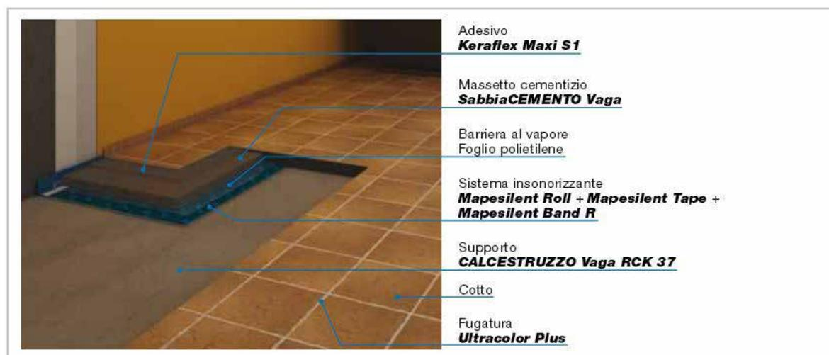
Figura 4.3.2 - Massetto galleggiante isolato acusticamente con SISTEMA MAPESILENT
