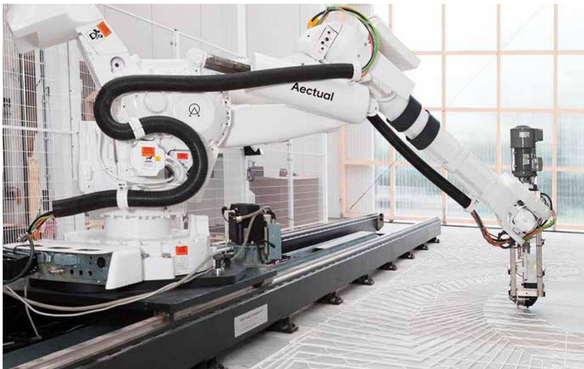
Nel dettaglio, per stampare la pavimentazione, l'azienda impiega enormi robot, con movimento a sei assi, che si spostano da un lato all'altro su rotaie.
