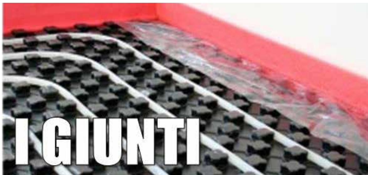
Il sistema radiante a pavimento subisce variazioni di temperatura e fenomeni di ritiro idraulico, determinando tensioni più o meno evidenti, legati alle dimensioni della lastra costituita.
