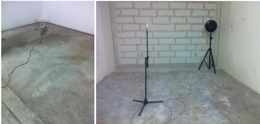
Immagine 5. Strumentazione superiore ed inferiore per le verifiche sperimentali dei pacchetti
