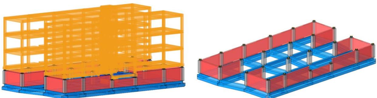
**Figura 2:** Sovrastruttura e sottostruttura
