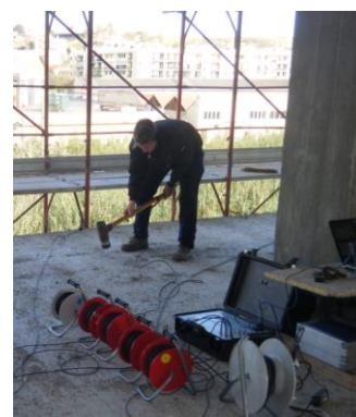
Fig1 – Esecuzione prova dinamica con martello strumentato
