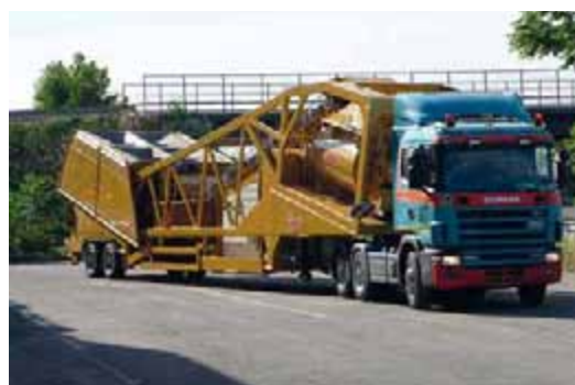
SOKOBETON (Tunisia) Impianto trasportabile Tipo TRAILER Modello IMETRAVEL 4/80 completo di premescolatore TWIN SHAFT TS.3000-2000 Produzione 80 mc./h. di cls. PREMESCOLATO
