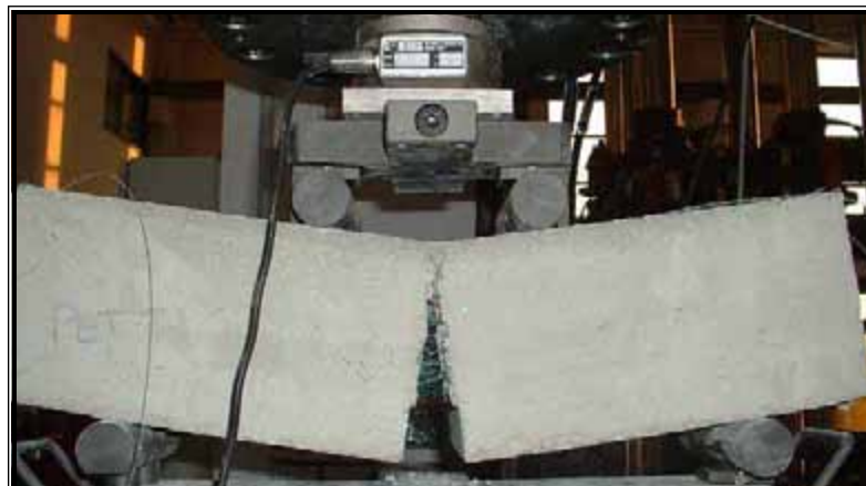
Figura 4 – Configurazione di collasso di un provino di RPETFR/a soggetto a prova di flessione su quattro punti.
