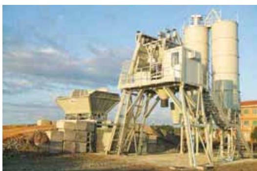
BRIZZI Escavazioni S.r.l. Impianto a RAPIDO MONTAGGIO Tipo STARMOBIL TWB completo di premescolatore Produzione 50 mc./h. di cls. PREMESCOLATO
