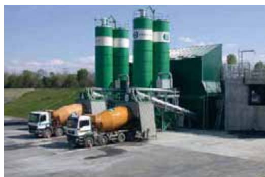
EDILCAVE S.p.A. Impianto Tipo DUPLEX completo di impianto per lavaggio autobetoniere Produzione 120 mc./h. (per OGNI punto di carico)
