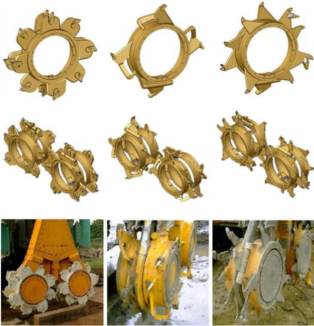
Figura 2. Ruote dentate del gruppo fresante BCM, da sn. Verso dx: Ruota da taglio (standard), Ruota miscelatrice e Ruota combi
