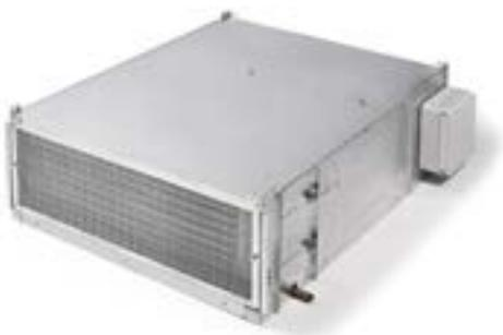
Fig. 03-5 Deumidificatore a soffitto LE-KD 24 L / LE K KD 21L: Capacità di condensazione 24 e 21 l/g - Portata aria nominale 320-300 m<sup>3</sup>/h
