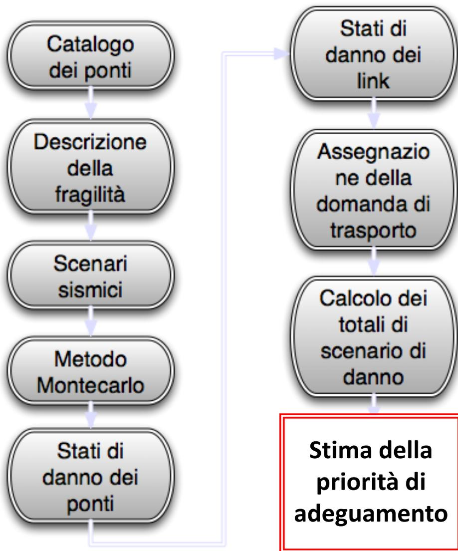
Stima della priorità di adeguamento tenendo conto della **risposta della rete stradale al possibile danneggiamento dei ponti dovuto al sisma**
