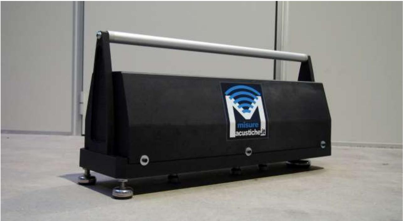
*Figura 2 generatore di calpestio normalizzato*
