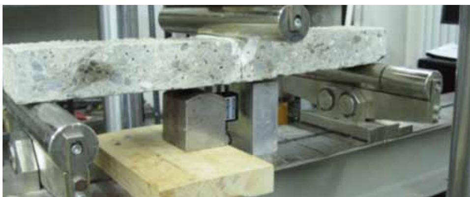
Set-up prova di flessione su tre punti
