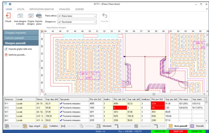
La possibilità di disegnare con lo stesso strumento sia impianti tradizionali, sia impianti a pavimento (possibile quando si posseggono entrambi i moduli: EC717 e EC718), rende il software EC711 un importante e completo strumento per la progettazione termotecnica. I dati delle tubazioni, degli apparecchi, dei pannelli e delle valvole possono essere ricavati da un ampio archivio, implementabile da parte dell'utente.
