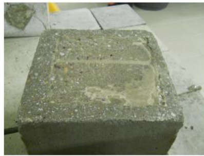
Rimozione dell'eccesso di Penetron mediante fresatura
