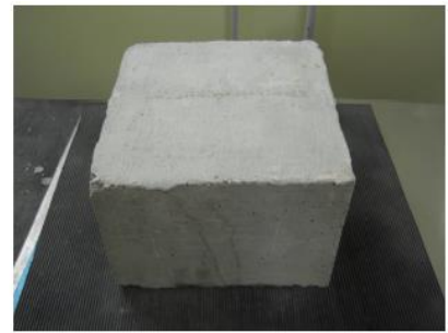
Applicazione strato definito di Penetron Standard
