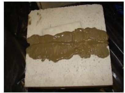
Riempimento fessura con Penetron Standard
