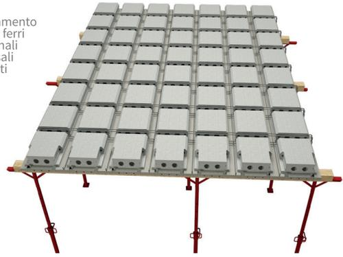
Procedere con la collocazione dei ferri longitudinali e trasversali nei travetti secondo quanto riportato dal calcolo.
