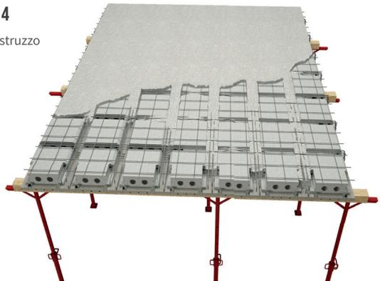
In fine completare con il getto e costipazione del calcestruzzo tramite vibratura, prima dei travetti e poi della caldana. L'EPS ha un bassissimo grado di assorbimento dell'acqua per tanto non è necessario bagnare preventivamente le superfici.
