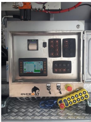
Foto: il pannello operatore con stampante integrata e il radiocomando bidirezionale.
