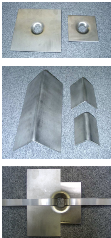
Figura 1 – Elementi in acciaio del sistema di rinforzo CAM: a) piastre imbutite; b) angolari; c) nastri
