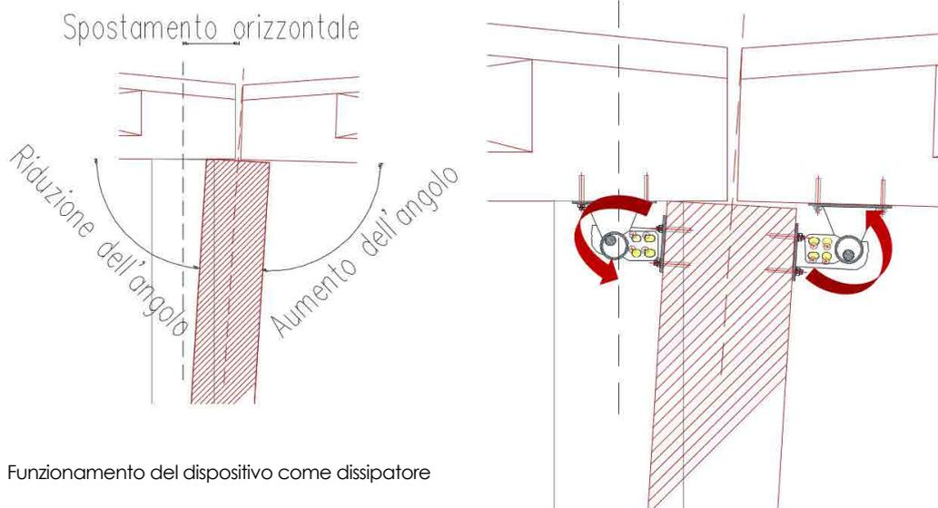
Nelle tre immagini sottostanti si dimostra in modo schematico come il dispositivo SAFE+ Model A sia in grado di mantenere il collegamento tra la trave e il pilastro sia per l'azione sismica orizzontale sia per quella verticale.
