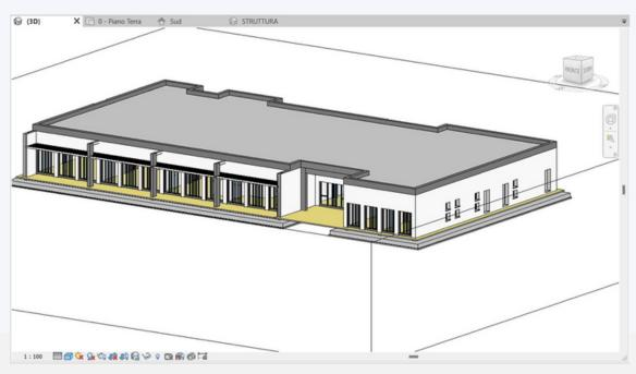
Completata la parte di modellazione, si è proceduto all'esportazione in formato IFC. Al fine di analizzare il solo modello strutturale, quindi evitando di trasferire la grande mole di informazioni presenti nel modello, si è creato un file di export dell'ossatura portante.
