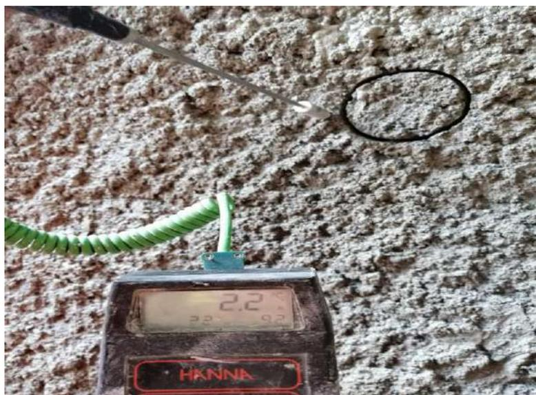
Temperatura fondo carotaggio : da  $-4^{\circ}\text{C}$  a  $-1^{\circ}\text{C}$
