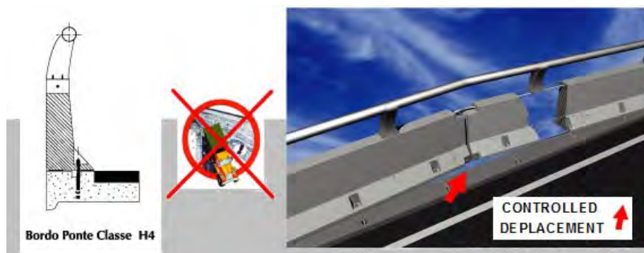
Fig. 21 Barriere da ponte “spostabili”: l’energia dell’urto rompe o deforma gli ancoraggi duttili senza che al ponte venga trasmessa l’intera forza dell’urto ed il veicolo viene ridiretto sulla strada, evitando anche il suo “roll over” sopra la barriera
