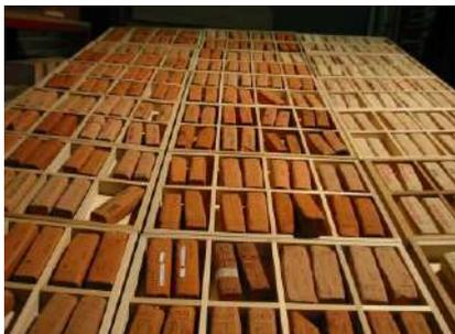
Il colore dei mattoni è dato dalla composizione dell'argilla (più o meno ricca di carbonato di calcio o ossidi) ed ogni tipo di argilla ha una sua temperatura di cottura (ci avviciniamo comunque al punto di fusione per garantire un'ottima resistenza al gelo ed assenza di efflorescenze carbonatiche) attorno ai 1.000°C. Ririro, percentuale di porosità, resistenza meccanica, colore, tonalità sono tutte variabili da calibrare durante la produzione.
