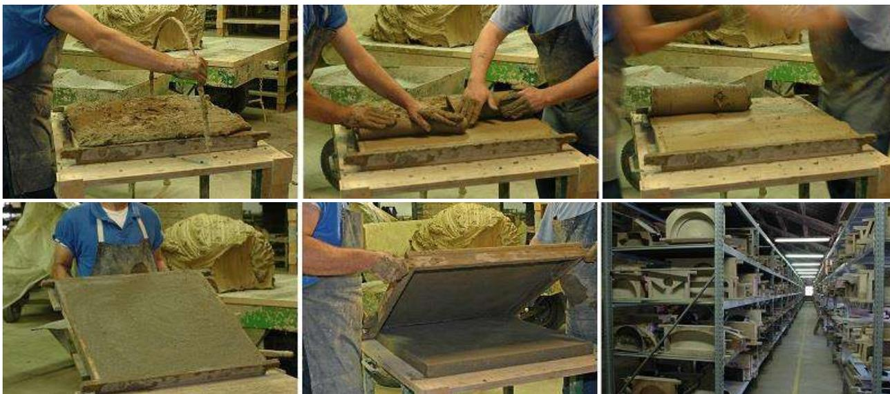
L'argilla impastata con acqua (circa il 40% del suo peso) deve perdere molto lentamente questa umidità per evitare cavillature e possibili discontinuità nella struttura cristallina, pertanto è necessaria dopo la formatura una essiccazione. Per i mattoni standard nella produzione industrializzata, avviene in essiccatoi a ventilazione forzata, per gli interventi di restauro e per la produzione customizzata all'aria in 30-40 giorni. Anche questo: ora come allora.
