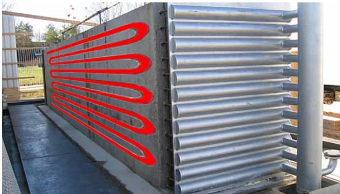
Figura 1. Schema di un modulo di accumulo di energia termica con calcestruzzo.
