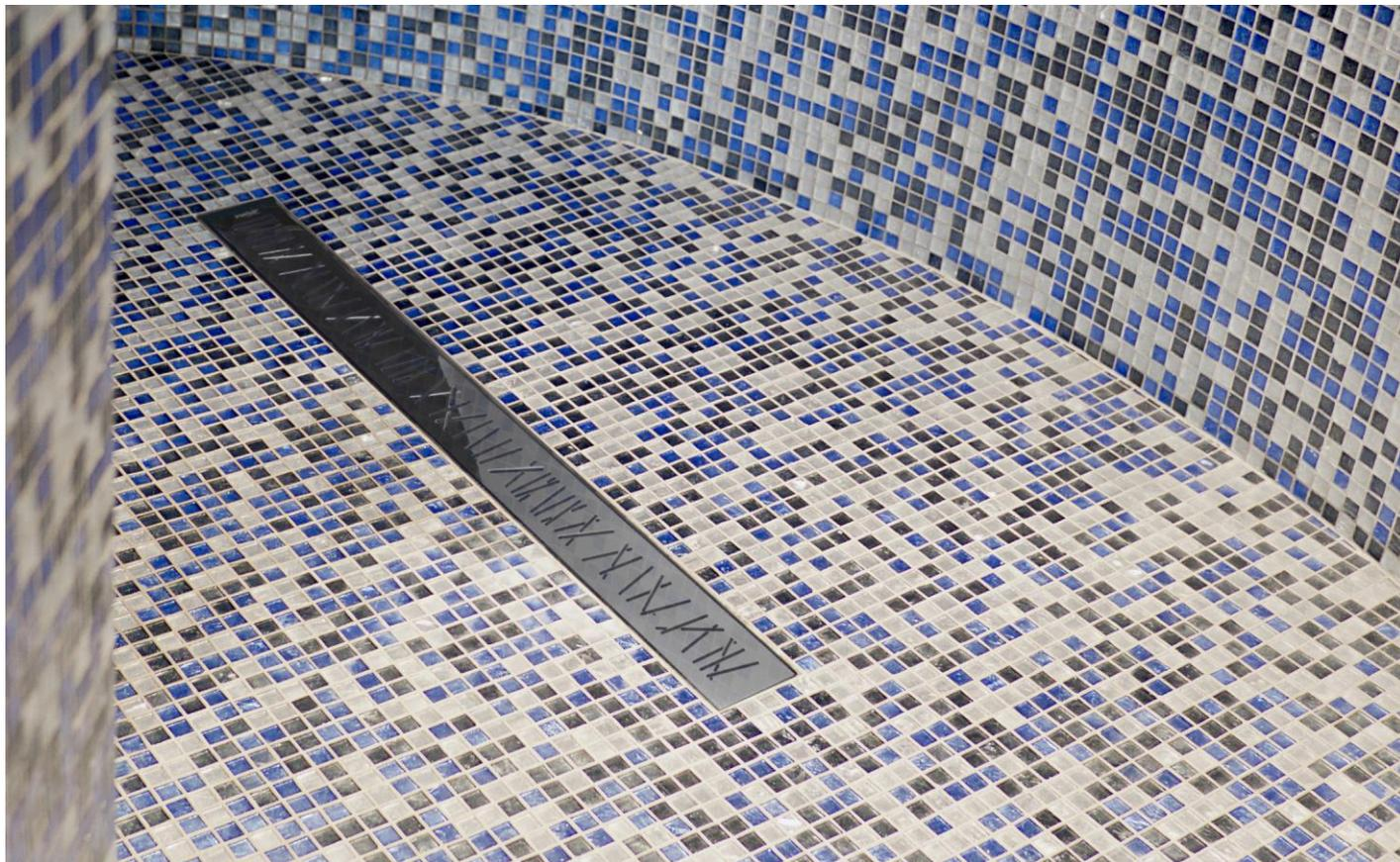
**Linea** – È un sistema composto da un corpo sifonato (o canaletta doccia) e da una vasta gamma di griglie in acciaio inox, caratterizzato da un ampio margine di personalizzazione. Si presta alla realizzazione di docce di ogni dimensione (le griglie sono disponibili in svariate lunghezze, dai 300 ai 1200 mm), e si adatta ad ogni esigenza di installazione grazie alla possibilità di regolare in altezza sia il corpo del sifone (da 111 a 143 mm) sia il supporto griglia (da 7 a 15 mm).
