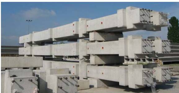
Figura 15 - Stoccaggio pilastri prefabbricati
