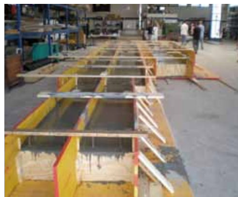
Trave W 770 PFRC sottoposta a prove di flessione
