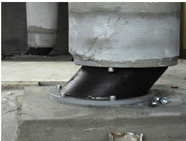
Figura 12. Due isolatori elastomerici predeformati, prima della fase di rientro elastico in posizione centrata.
